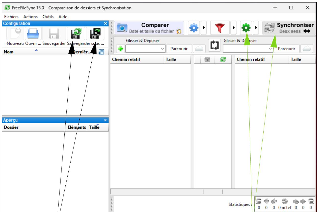
Cliquer sur l'icône d'enregistrement avec le logo sycro pour le sauvegarder dans le logiciel ou Cliquer sur l'icône d'enregistrement avec le logo d'un terminal pour pouvoir juste cliquer sur le fichier et Lancer la syncro
